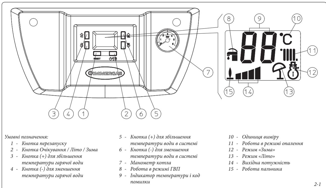
**Увімкнення котла.** Перед увімкненням котла необхідно заповнити систему водою, перевіряючи, щоб стрілка манометра (7) вказувала на значення у межах між 1 та 1,2 барами.
